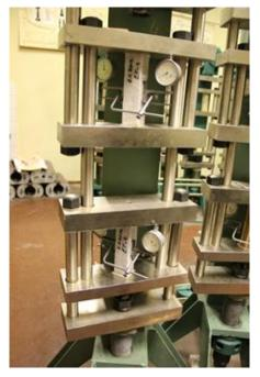
Fig. 3. Creep lever test stand
