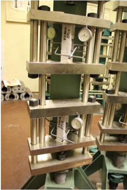
**Fig. 3. Creep lever test stand**
