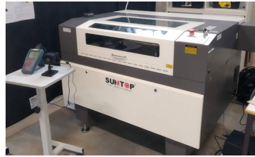
Fig. 2. SUNTOP ST-CC9060 CO 2 laser system.
