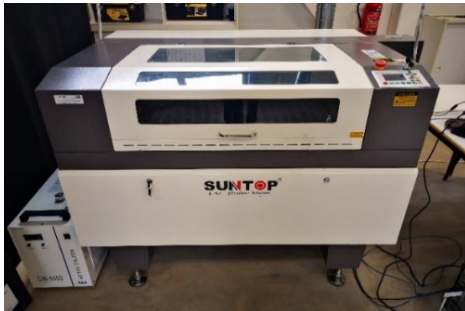
Fig. 1. SUNTOP ST-CC9060 CO 2 laser machine.
