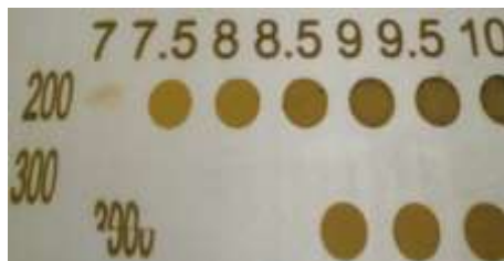
3.attēls Lāzermarķēšanas eksperimenta rezultāti uz PVC materiāla paraugiem
