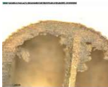
8.attēls Materiāla sabrukšana ko izraisa marķēšana pie jaudas kas pārsniedz 12 (W) un ātruma kas ir zemāks par 200 (mm/s)
